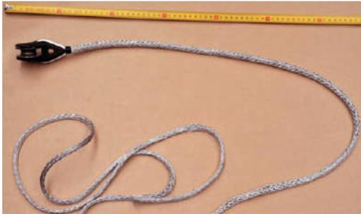
12/ Lubrifier la gaine Dyneema<sup>®</sup> en contact avec l'anneau (lubrifiant INO-ROPE<sup>®</sup>).
