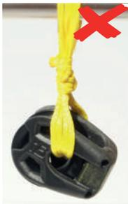
Absence d'une demi-clé sur le lashing (un par extrémité au lieu de 3 par extrémité)
