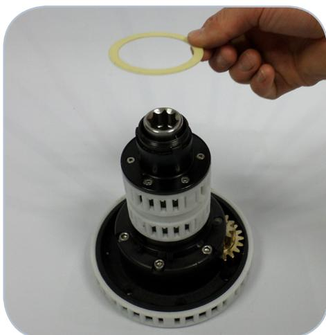
5. Retirer la rondelle d'appui
