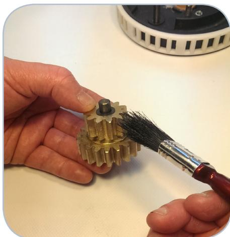
3. Nettoyer les engrenages et les axes. Graisser les modérément à l'aide de la graisse Pontos, tout excès risque de retenir le sel
