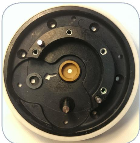
La flèche dans l'embase indique la position du pignon de sortie pour une installation correcte.
